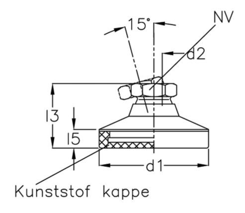
d1 = 25 d2 = 8 l3 = 20.5 l5 = 5.5 NV = 12 Static load (N) = 10 t min = 9
